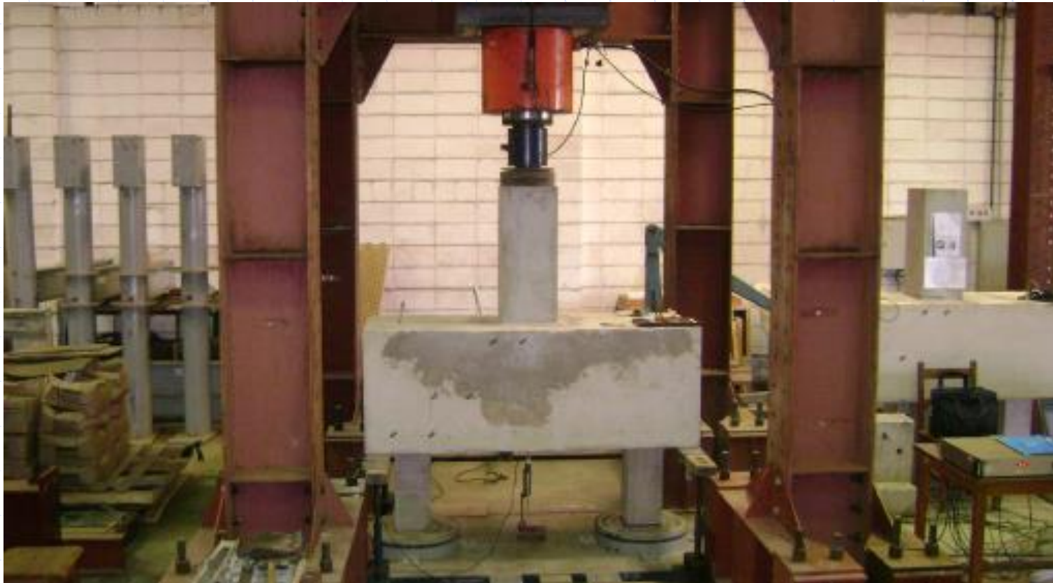
Estrutura de reação.
